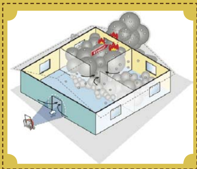
圖1 | 正壓通風排煙示意圖(圖片來源: Tempest Technology, Inc. 網址: http://www.tempest-edge.com/ppv/index.htm )
