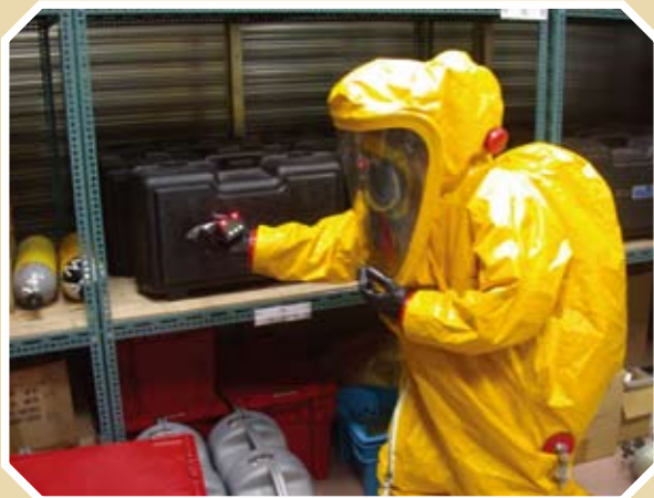
圖4 | 穿著A級防護衣執行未知危害物現場偵測含氧量與易爆性氣體濃度
