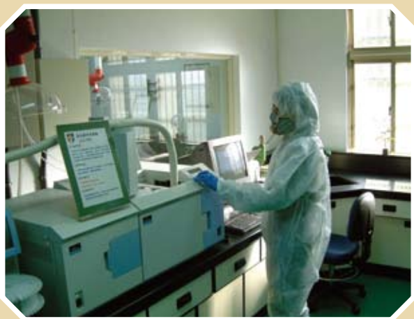
圖6 | 危害物採樣後送執行氣相層析質譜儀(GC/MS)的分析確認(陸軍化學兵學校防研中心提供)
