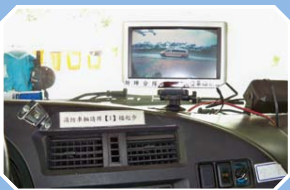
圖4 | 消防車儀表板上方裝設螢幕顯示器可顯示車後影像
