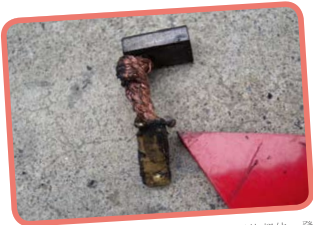
圖8 | 電刷與啟動馬達正極端子接合金屬片部位，發現有受高溫變形呈圓熔狀（紅色箭頭處）。
