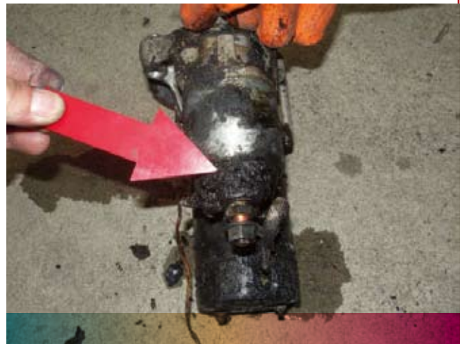
圖5 | 引擎本體後側塑膠進氣歧管燒失，啓動馬達（紅色箭頭處）周圍塑膠零件及管線外披覆燒熔以靠啓動馬達周圍較為嚴重。
