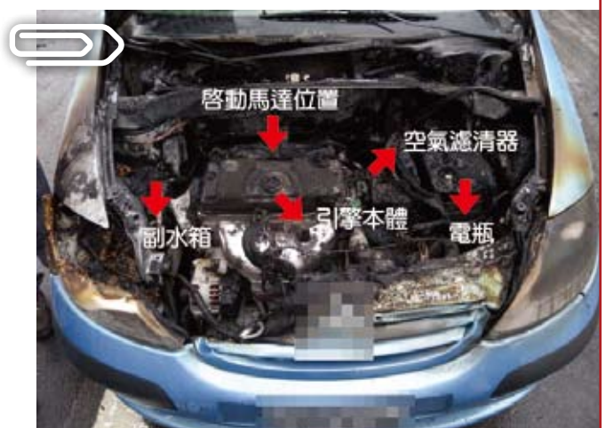
圖3 | 引擎室內引擎本體上蓋受燒變色以後側較為嚴重，塑膠零件外殼燒熔軟化，電線絕緣外層燒失，銅線裸露。
