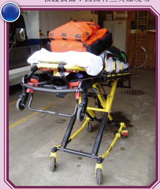
圖6 | EAGLE RIVER AREA救護車配置之擔架可是完全靠電力自動升降，不必靠人力徒手搬運。
