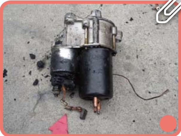
圖9 | 拆解後將電刷與啟動馬達正極端子復位後，接合金屬片二端皆有受高溫變形呈圓熔狀之痕跡。
