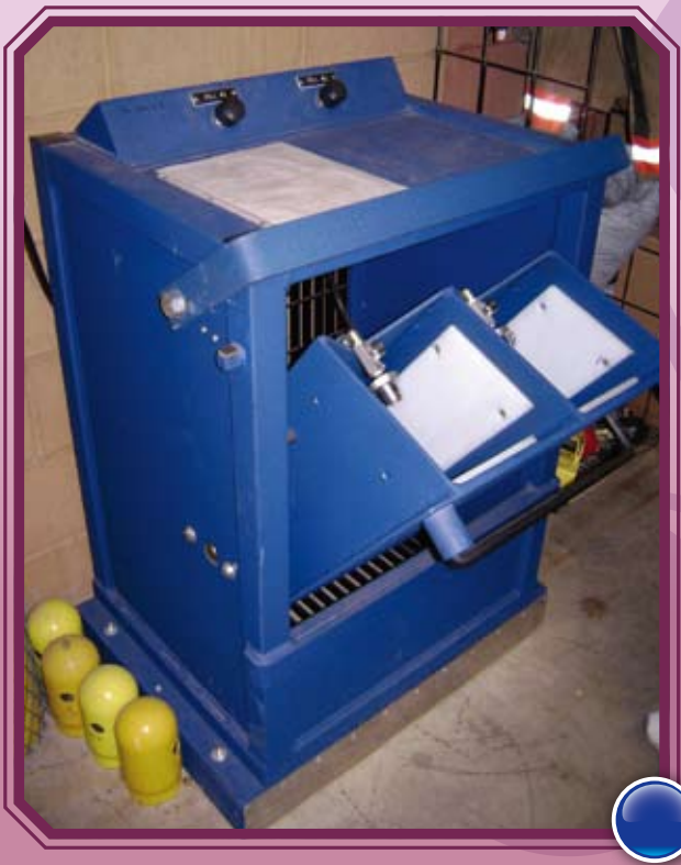
圖8 | 此為HONUGHTONFIRE DEPARTMENT消防隊空氣瓶灌充之安全防護設備，有點類似防爆箱固定裝置。
