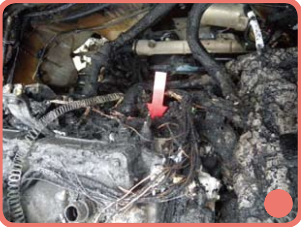
圖2 | 引擎本體上方引擎汽缸蓋受燒變色以後側較為嚴重，引擎本體下方及排氣管前段上蓋輕微燻黑。
