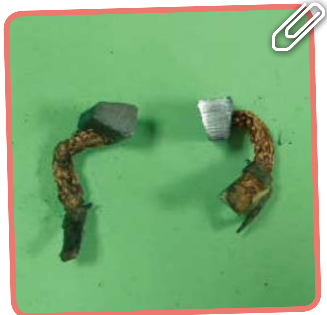
圖10 | 經查與一般換裝才使用1星期之啟動馬達比較，本火災案之啟動馬達電刷有過度磨損之情形。
