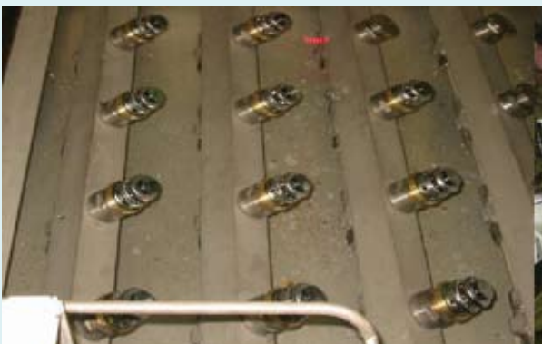
圖14 | 撒水頭耐洩漏試驗
