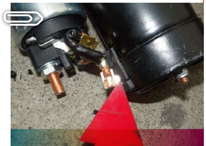
圖7 | 啓動馬達正極端子與電刷接合金屬片受高溫變形呈圓熔狀（紅色箭頭處）。
