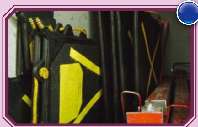
圖12 | WAUSAU FIRE DEPARTMENT消防車輛隨車配有大量固定倒塌建物或傾斜車輛之充壓式固定器材。
