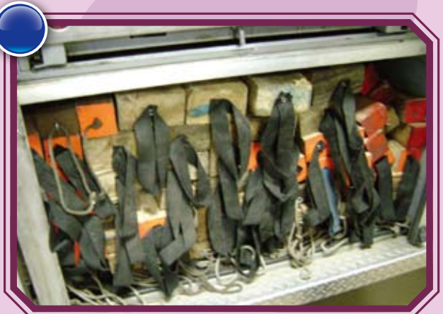
圖11 | WAUSAU FIRE DEPARTMENT消防車輛隨車配有大量固定倒塌建物或傾斜車輛之枕木固定器材。
