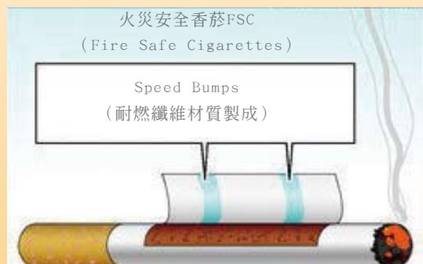
圖五 | 火災安全香菸構造
