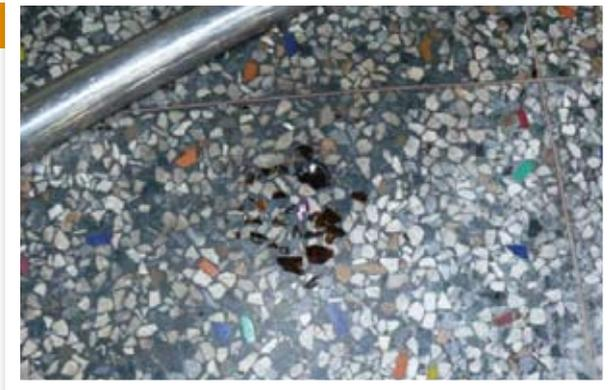
圖3 | 經火災調查人員於現場採集之玻璃罐殘骸，經比對為坊間蠻牛飲料瓶罐。
