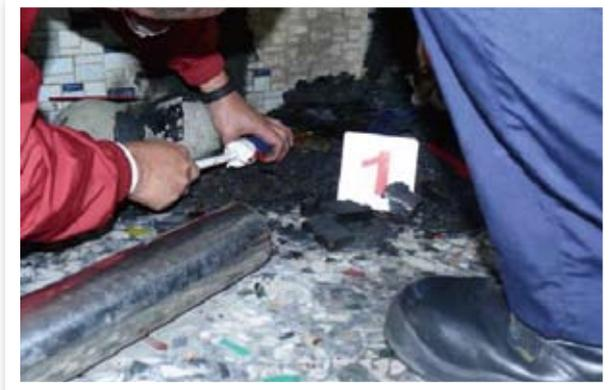
圖4 | 經本局火災調查人員以火災現場調查用氣體檢知器檢測發現汽油檢知管呈墨綠色變色反應，研判為一起縱火案件。
