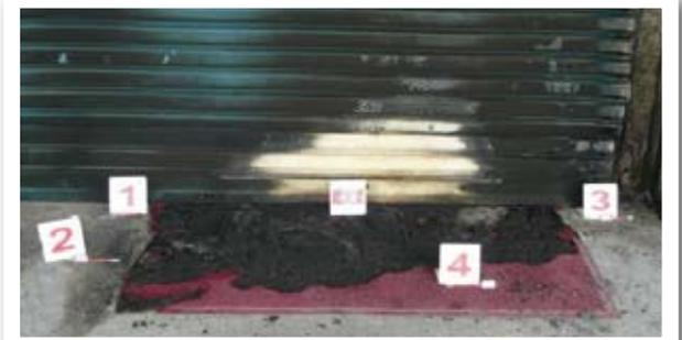
圖7 | 火災調查人員以火災現場調查用氣體檢知器檢測腳踏墊受燒損之四處並予以編號為1、2、3、4，發現編號1、2、3、4汽油檢知管均呈墨綠色變色反應。
