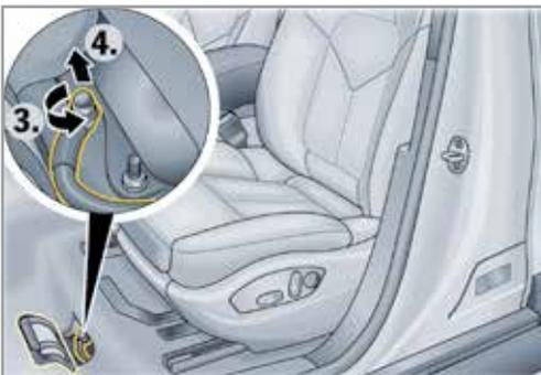
3. 斷開螺絲接線端 (-3-) 的 12 伏特電池接地纜線。
