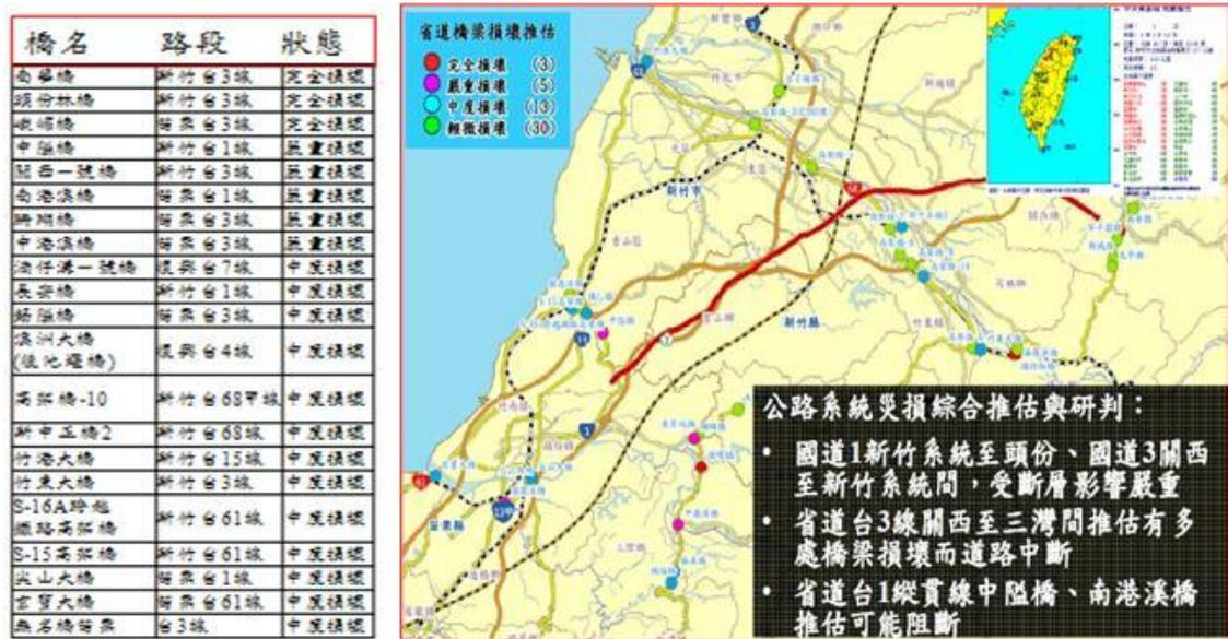
圖 150、災損推估專業軟體的公路橋樑損失評估圖
