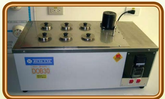
圖 | 耐油試驗機。
