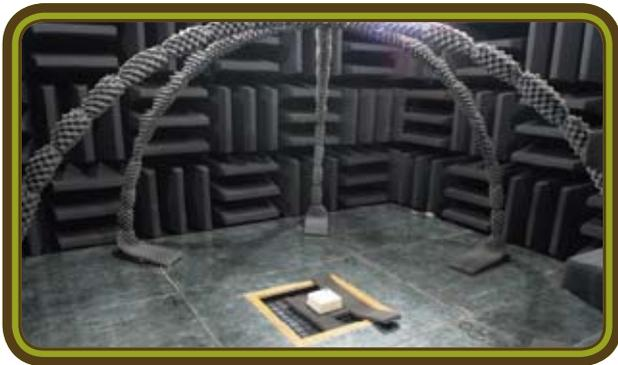
圖 | 音響功率試驗。
