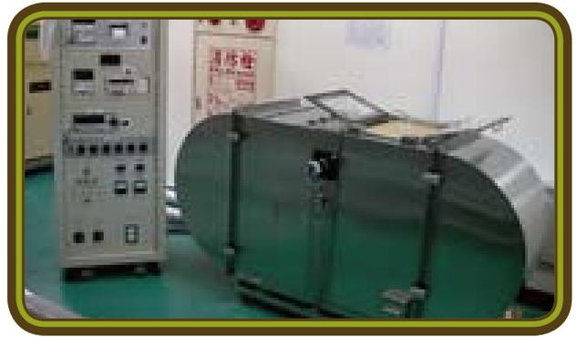
圖 | 煙靈敏度試驗機。
