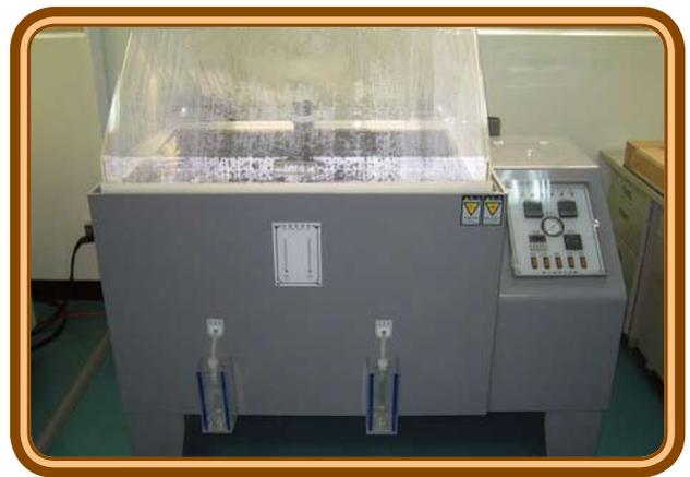
圖 | 鹽霧腐蝕試驗機。
