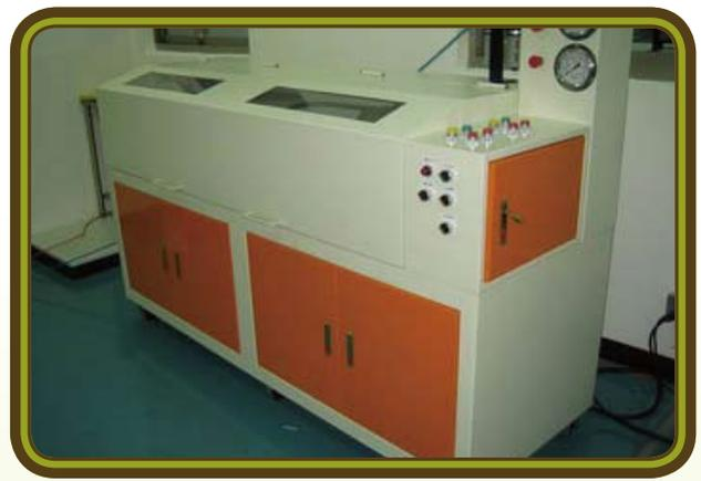
圖 | 耐水壓試驗機。
