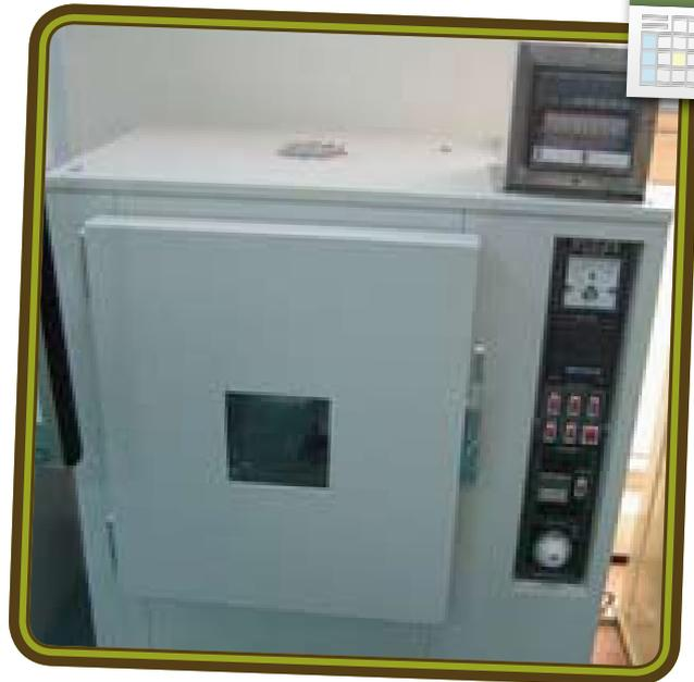
圖 | 老化試驗機。
