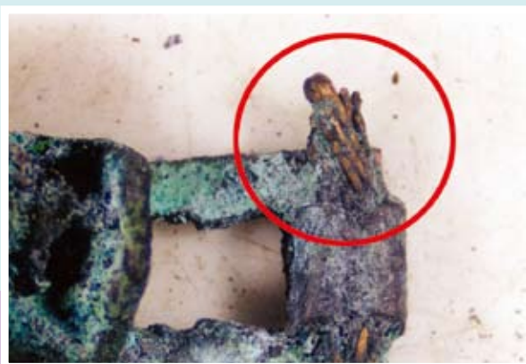
圖10 | 電冰箱插頭之一側刀片包夾在轉接插頭熔斷刀座燒熔物內(A)，在電冰箱插頭兩極接線處，則發現有短路痕(B)。
