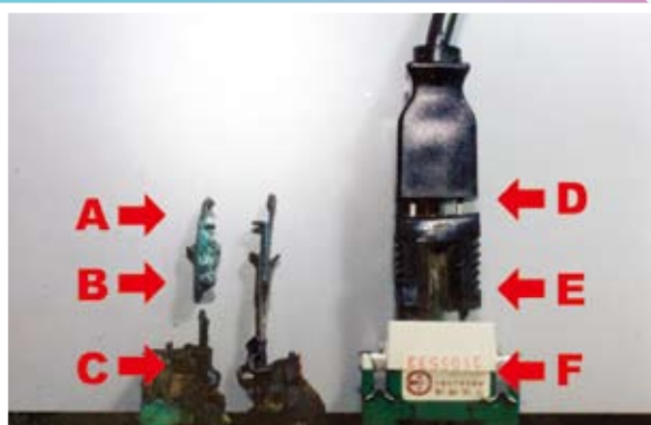
圖9 | 與同型品比對，該電冰箱插頭爲附有接地極之插頭(A、D)，經轉接插頭(B、E)插於雙孔式牆壁插座(C、F)上，其中轉接插頭(B)之一側刀座有局部熔斷現象，熔斷之刀座處夾雜燒熔物。
