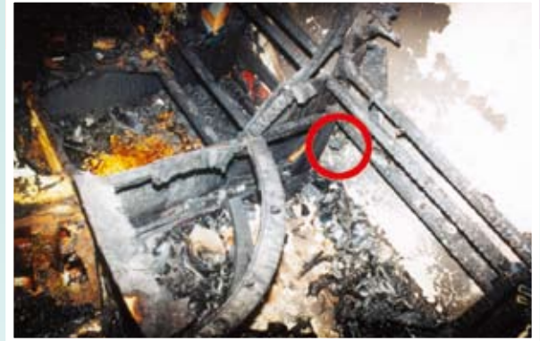
圖7 | L型沙發轉角椅木質結構燒損情形，其中以北側椅背木條燒失及碳化龜裂痕跡較嚴重。轉角椅背左下方牆壁有1個雙孔插座插有1條電源線（紅色圈）。
