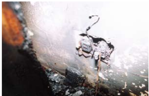
圖8 | 「牆壁插座所插接電源線，經詢問當事人爲冰箱之電源線，其插頭及塑膠絕緣物已燒失，插頭刀片及導線裸露。」
