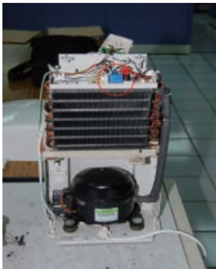
圖4-6-3 瑕疵除濕機及捕蚊燈連續致災
