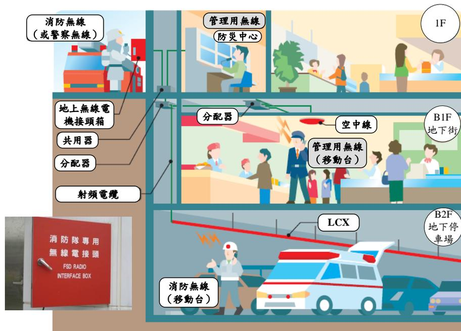
圖 2-37 無線電通信輔助設備 (資料來源：同註 1)
