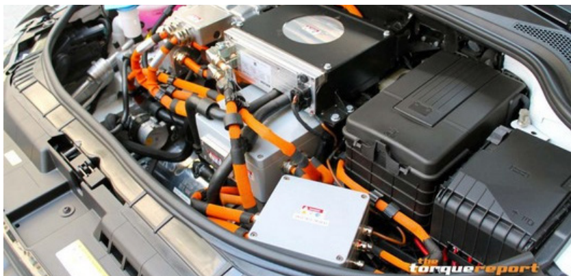
▲高電壓橘色線路
