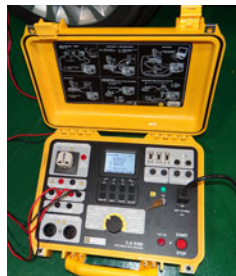
▲ 絕緣電阻量測儀器
