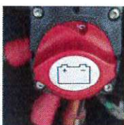
整車電源開關-關閉
