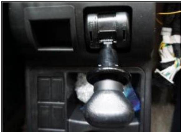
駐車制動可兼做緊急制動。通過操縱手制動閘手柄使彈簧儲能制動氣室起作用，實現駐車制動。當行車煞車系統出現洩漏等故障時，可採用駐車制動，實現車輛的緊急制動。
