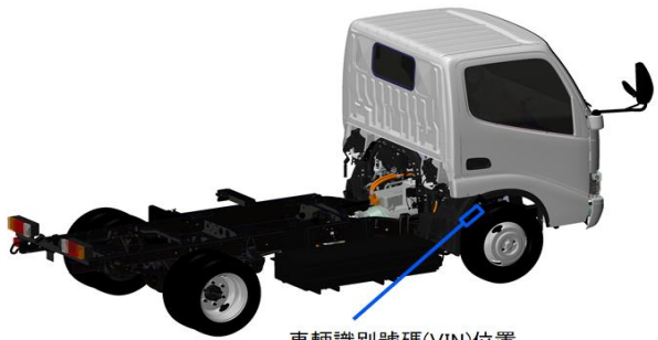
車輛識別號碼(VIN)位置 (此號碼刻印在右前大樑上)
