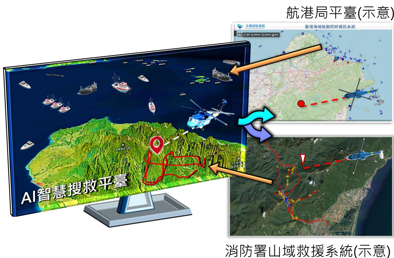
圖 4-3 AI 智慧搜救平臺與各機關系統資料交換示意圖
