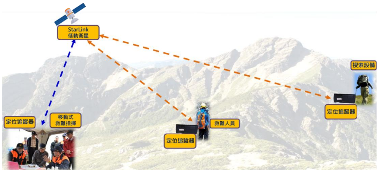
圖 2-6 搜索設備定位追蹤器運作機制及概念圖(山區)
