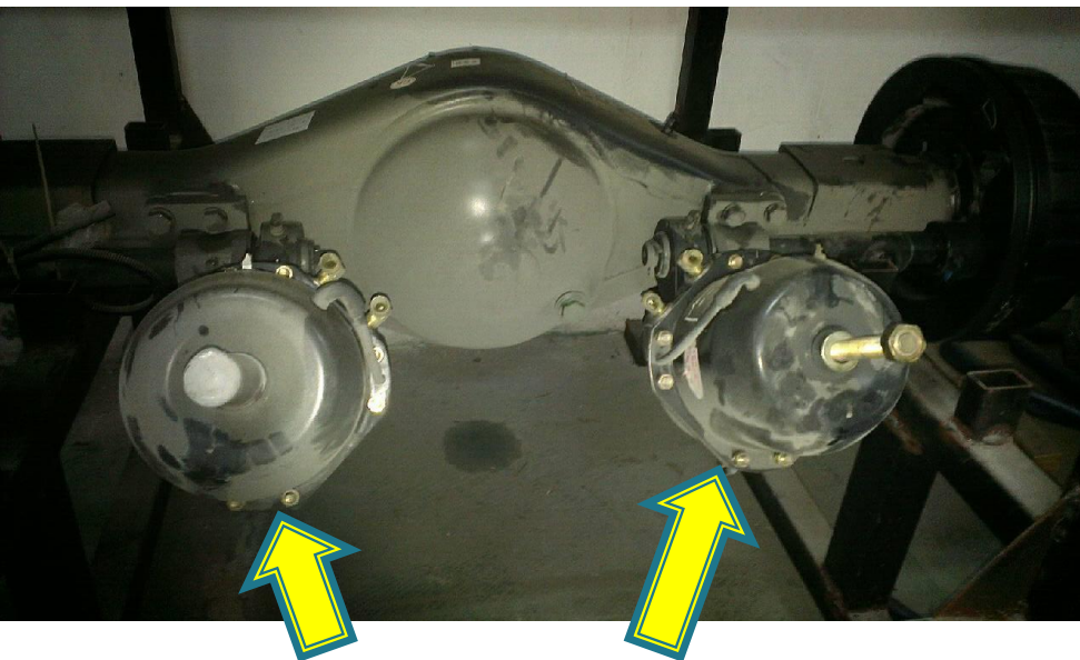
中巴後軸外觀和煞車風鼓位置
