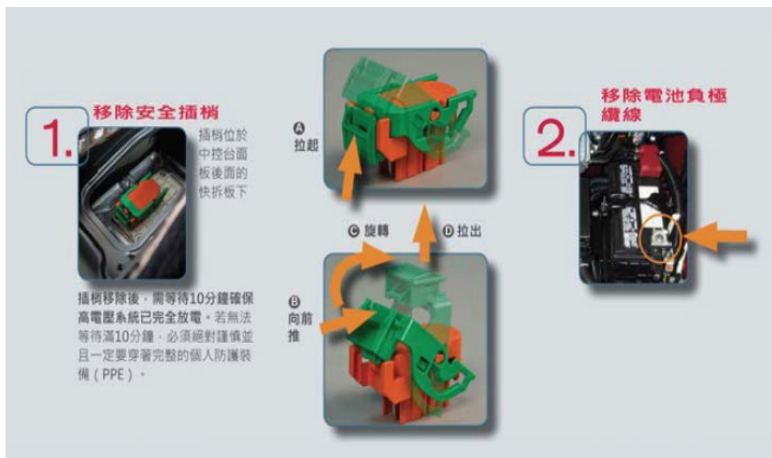
▲ 電動車電源緊急關閉程序圖例 (Nissan Leaf First Responder's Guide)
