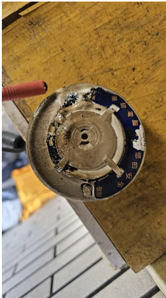
圖二：住警器動作情形(裝設客廳天花板，火警燒損掉落)
