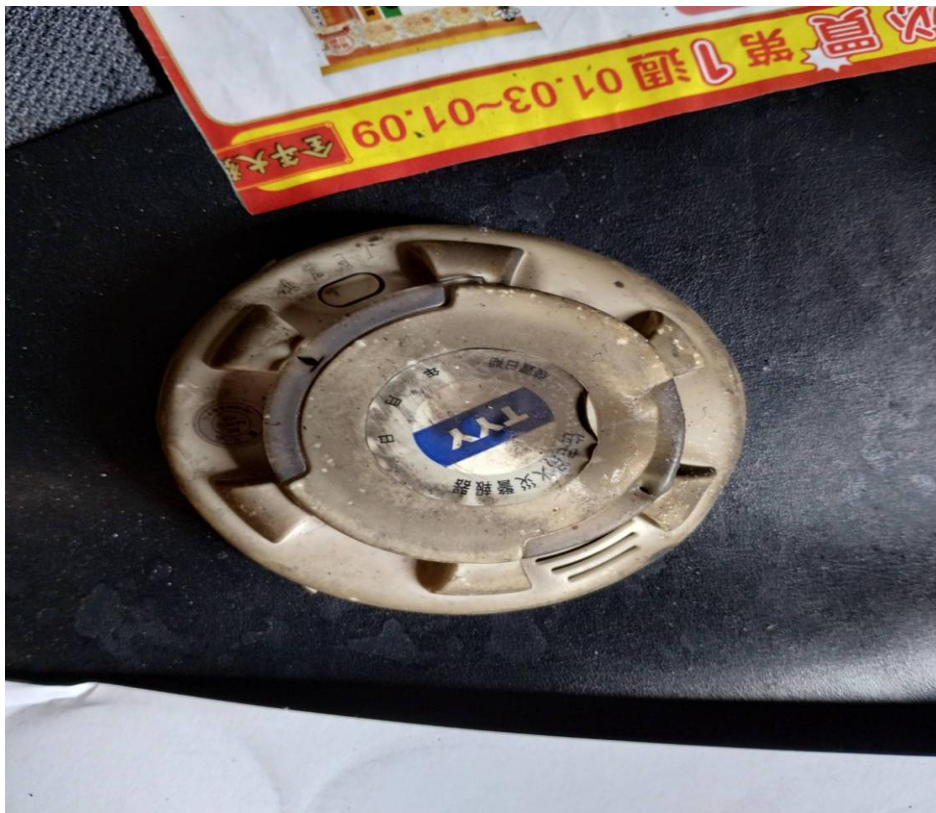
說明：火災現場住警器狀況(掉落於客廳地面上)
