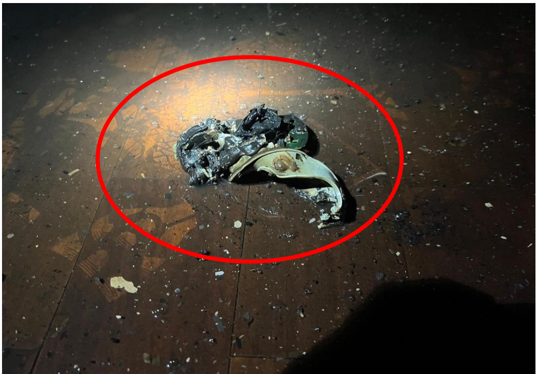
圖二：住警器動作情形(住警器因燒毀掉落)
