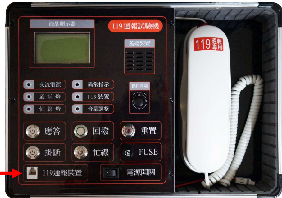
119火災通報裝置試驗機
